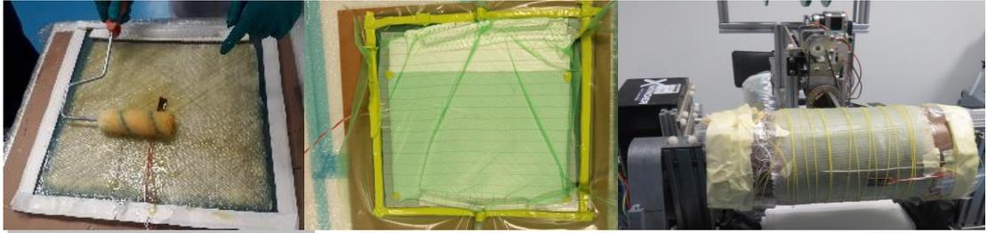
**Figura 2.** Pruebas laboratorio con sensores DC y FBG (izda.: laminación manual, centro: infusión, dcha.: filament winding).
